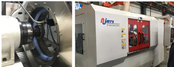
图7 Y4830CNC型数控内齿珩轮强力珩齿机
